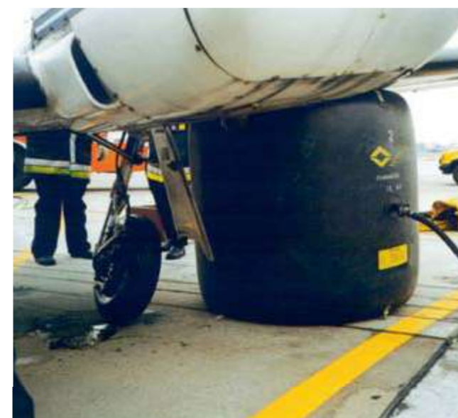
Аккуратное поднятие тонкостенных конструкций.
